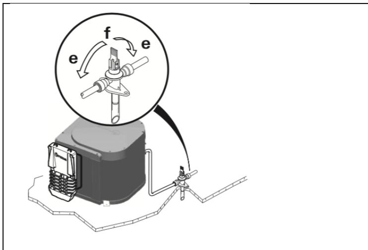
Si le véhicule n'est pas utilisé pendant la période de gel, le chauffe-eau Truma doit être purgé dans tous les cas.
